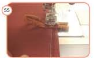
Lipat 2 penyangkul jam dan jahit. Pastikan kedudukan penyangkul jam berada di tengah bahagian atas, belakang kadkod.
