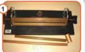
Langkah 1 hingga langkah 3. cara menyediakan dan memasang 11 batang jarum mesin smoking pada mesin smoking.
