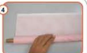
Langkah 4 hingga langkah 10. Cara menggulung kain pada kayu dan memasukkannya pada mesin smoking. Gulung bahagian lebar kain A berukuran 4" pada kayu. Pastikan kayu dilebihkan 2" sebelum kain digulung.
